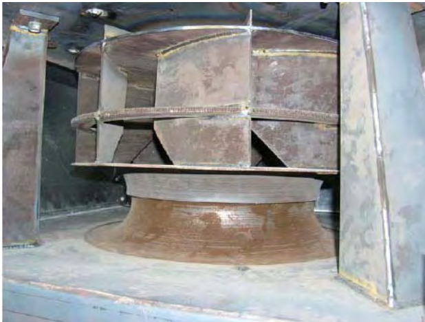
ODT-SVK 630-4 po požarnem preizkusu iz 11.07.2006 ODT-SVK 630-4 after fire test from 11.07.2006
