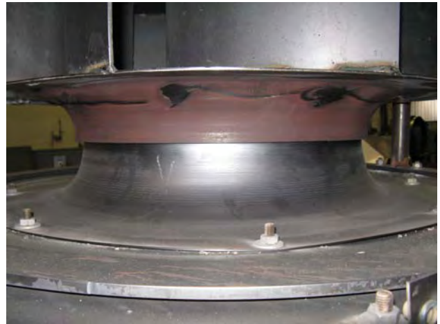
ODT-SVK2 800/710-4 tekač po požarnem preizkusu ODT-SVK2 800/710-4 impeller after fire test
